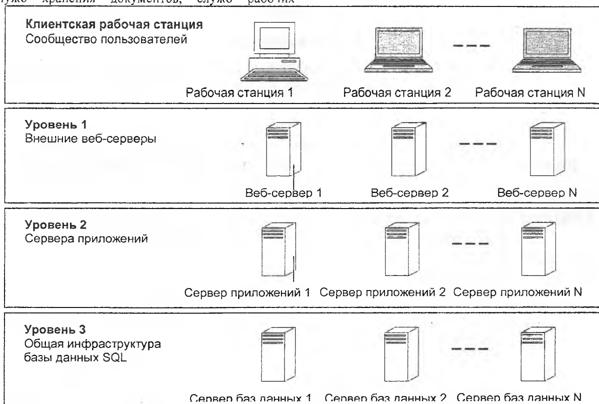
Рис. 2. Трехуровневое развертывание серверов.
